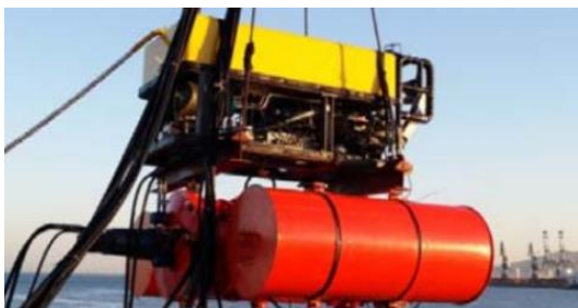
图5 ROV 携带水下抽油清污一体化机
