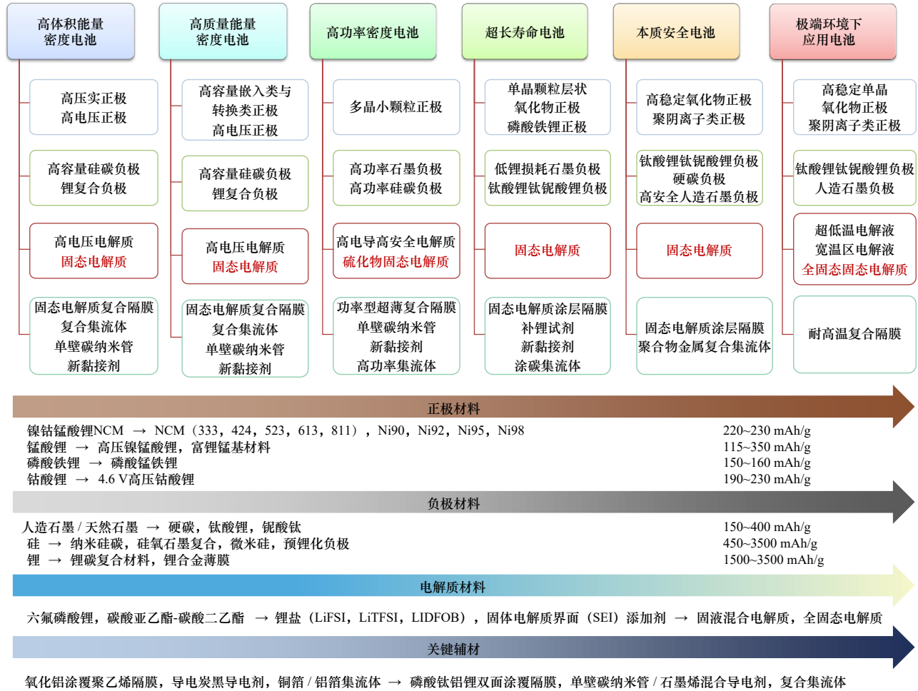
图 1 固态电池关键材料体系发展进程 注: NCM 表示镍钴锰正极。
