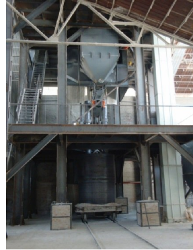
图7. 重大耗能设备——电熔镁炉。
