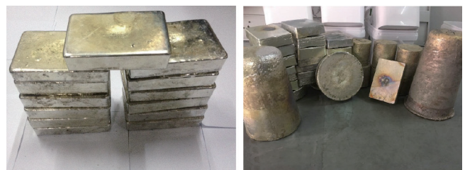
图9. 采用微波熔炼浇铸的锡锭。
